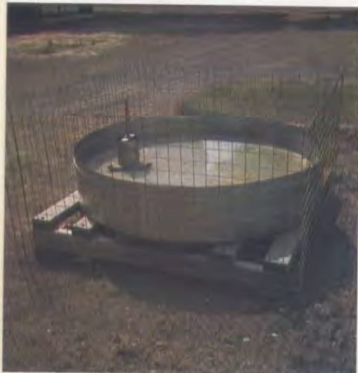
Vasca evaporimetrica impiegata per il calcolo dei volumi di adacquamento
