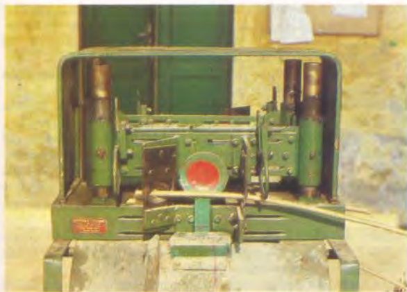
Fig. 1 - Macchina «tagliatalee». Funziona ad un ritmo di 27 battute al minuto sui due lati (anteriore e posteriore). In pratica due operatori riescono a tagliare circa 2.500 talee all'ora.
