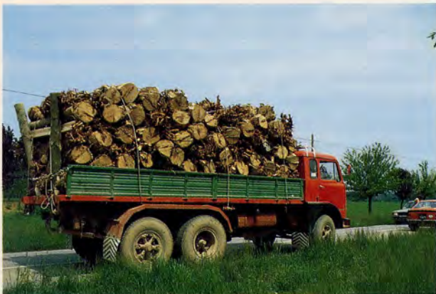
Fig. 7 - Trasporto delle ceppaie, estratte con cavaceppi, nelle fabbriche per la produzione di pannelli ricostituiti.
