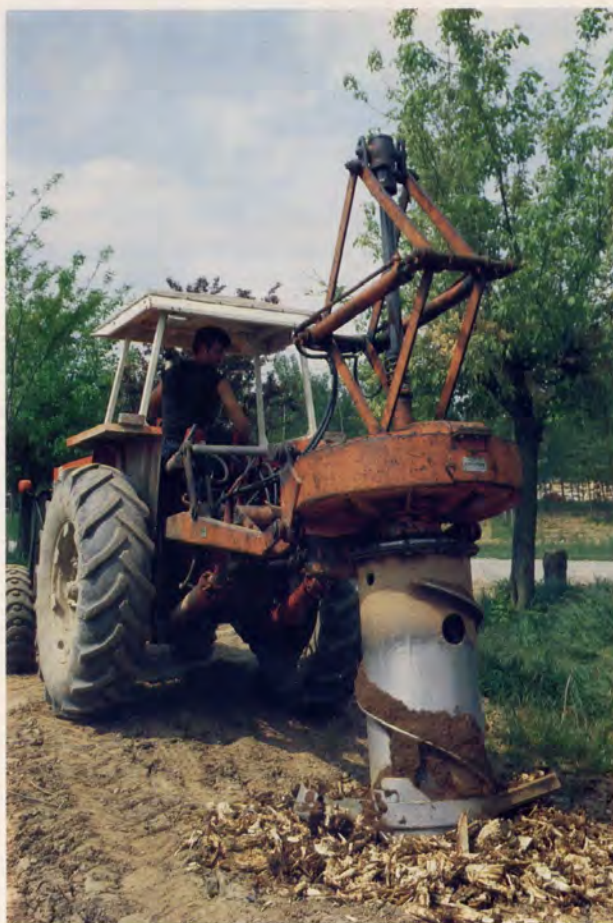
Fig. 6 - Estrazione delle ceppaie in campo con cavaceppi.
