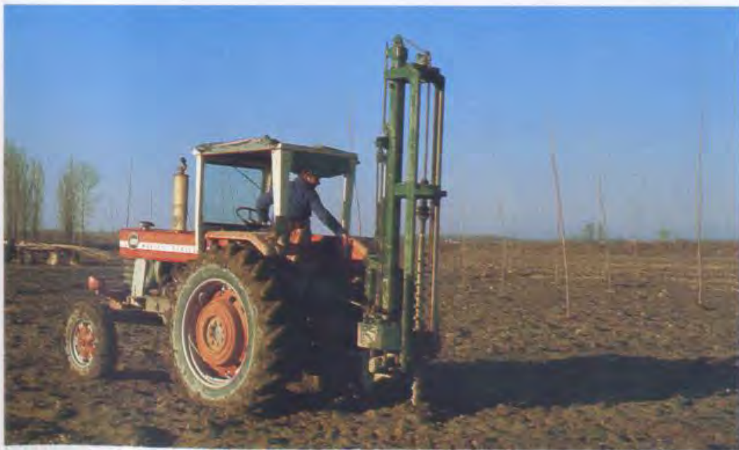
Fig. 9 - Trivella "Ellettari" per l'impianto profondo (1,50-3,00 m) degli astoni di pioppo.
