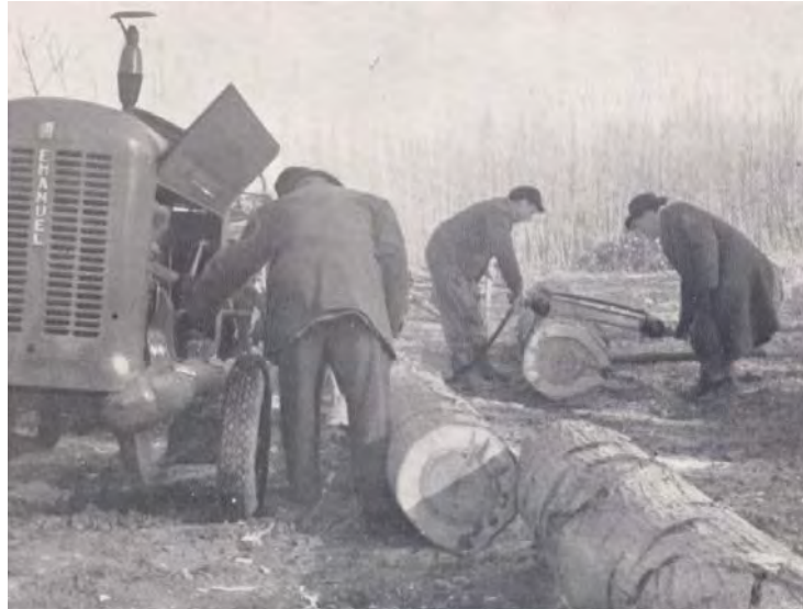
Depezzamento dei tronchi con sega pneumatica azionata da un trattore. 1953
