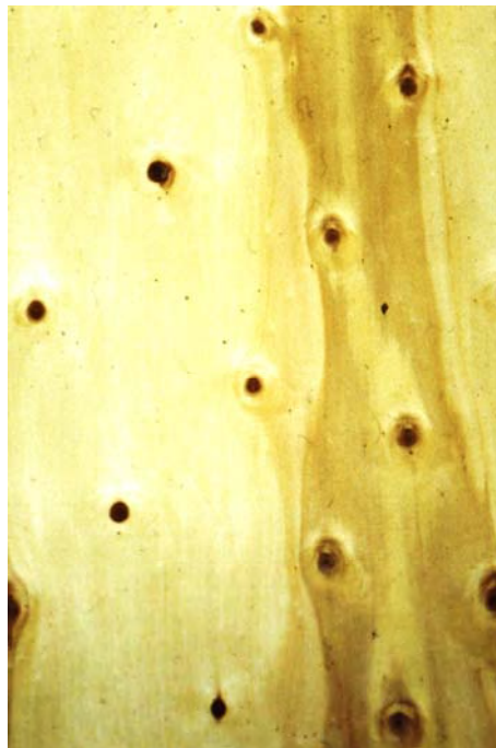
Chiarabba (1960): le conseguenze della presenza di un nodo nel tronco nel tappeto di derulatura.
