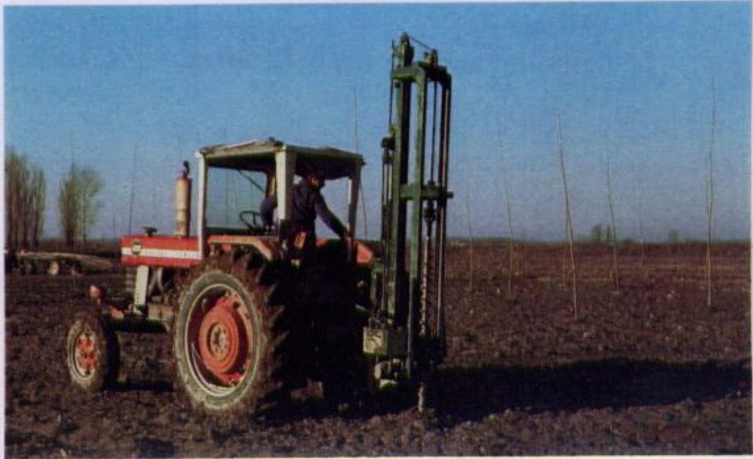
(Şekil-9) Köksüz fidanların derin dikimi (1.50-3.00 m) için "Elettari" modeli burgu.
