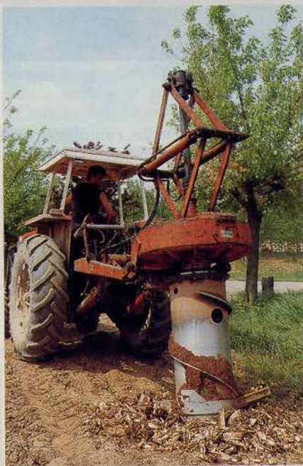
Estrazione delle ceppaie in campo con cavaceppi
