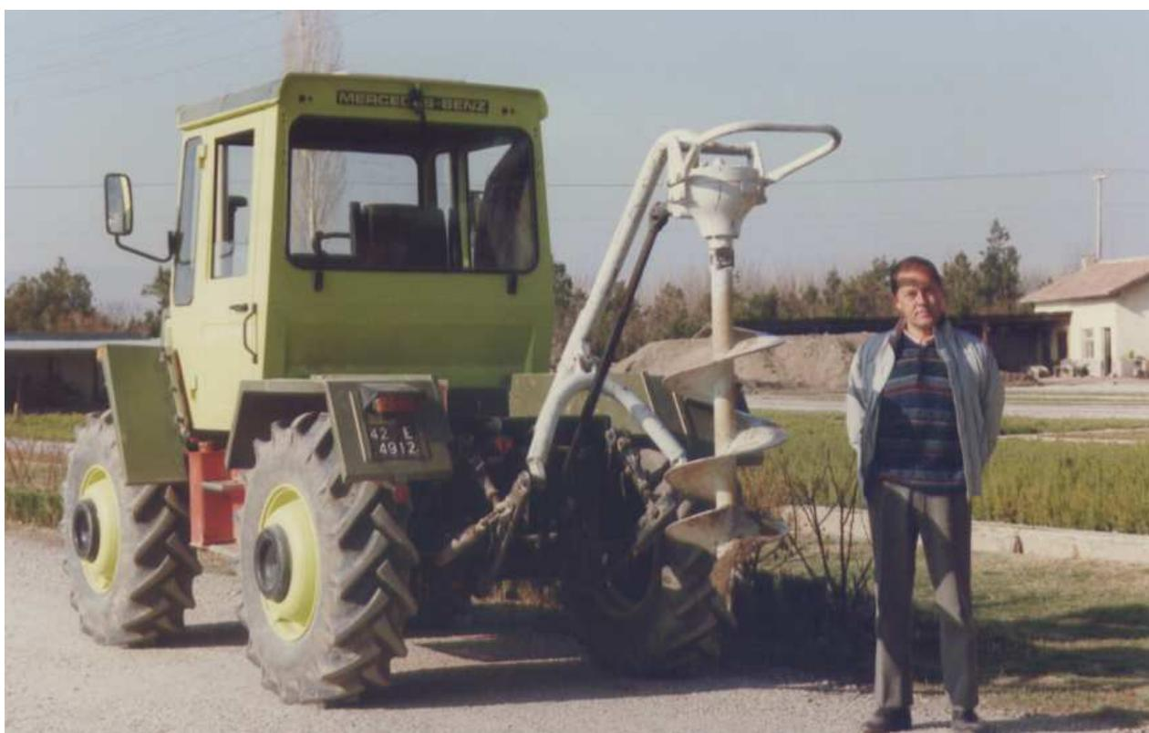
Trivella per l'apertura delle buche utilizzata per l'impianto dei pioppeti pilota.
