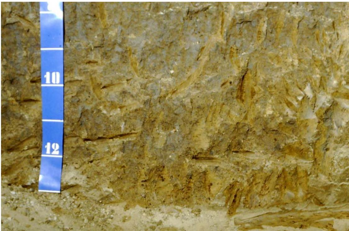
**Buronzo (VC). Strati profondi del terreno di cui alla foto 1: si noti la presenza di screziature persistenti dovute a difficoltà di drenaggio.**
