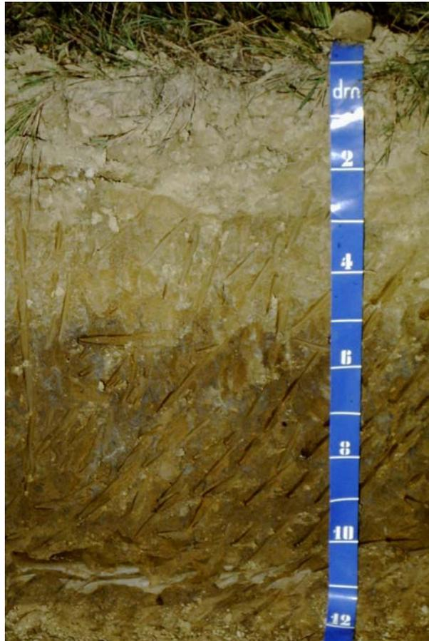
**Foto i Buronzo (VC). Profilo del terreno che ha ospitato il pioppeto di cui sono state condotte le prove di calcitazione: si noti la differenza di colorazione tra lo strato attivo (lavorato), topsoil, e quello inerte, subsoil.**
